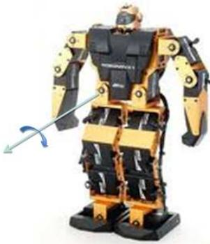
Figura 10: Representación del eje de giro del *twist* 1
