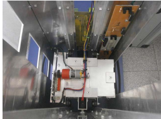
Figura 39. Cabina y placa sensores planta.
