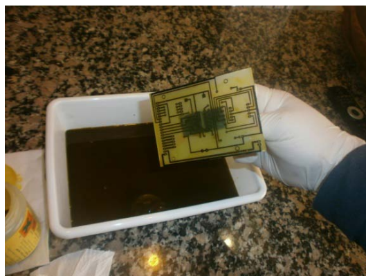
Figura 10. Placa de la botonera después del ataque químico I.
