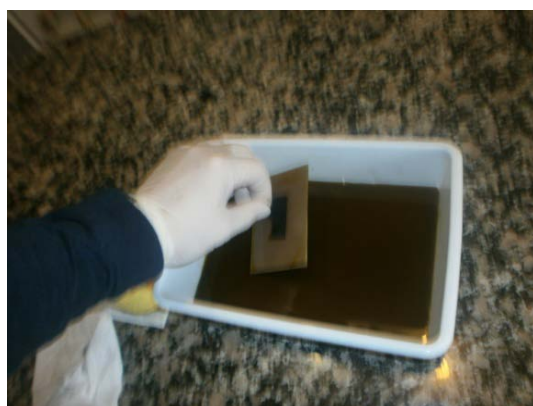
Figura 9. Introduciendo placa botonera en el cloruro férrico.
