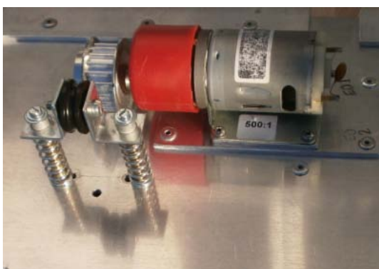
Figura 2. Mecanismo de elevación con sistema de muelles.
