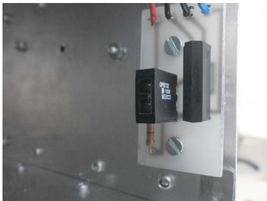
Figura 15. Placa sensor anti-atrapamiento.
