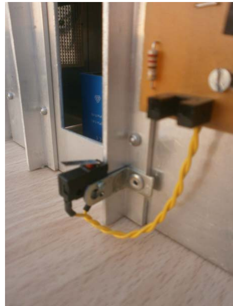
Figura 32. Microrruptor, Final de carrera inferior.
