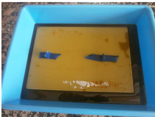
Figura 20. Placa de relés dentro de la bandeja con cloruro férrico.
