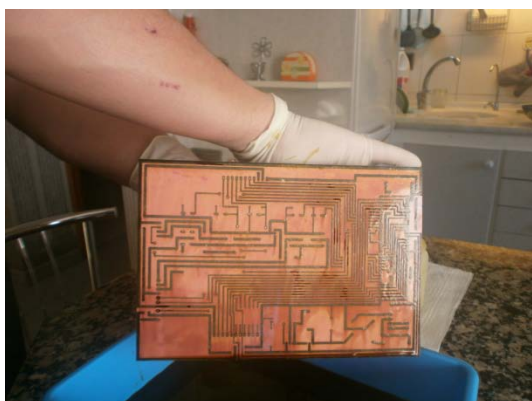
Figura 21. Proceso de ataque químico sobre la placa.
