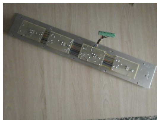
Figura 25. Placa pulsadores y leds en planta.
