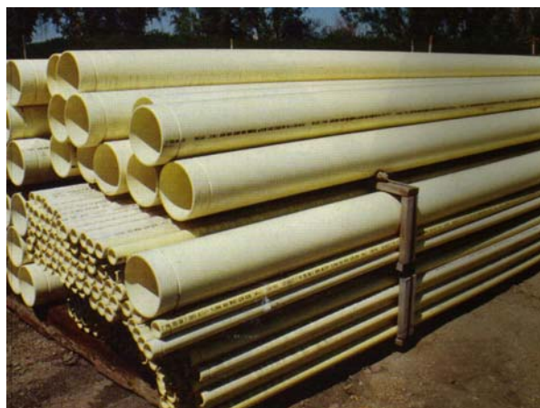
Foto 9. Tubería de PVC
