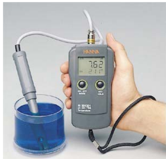
Foto 32. Medidor de pH y Conductividad Eléctrica Hanna.
