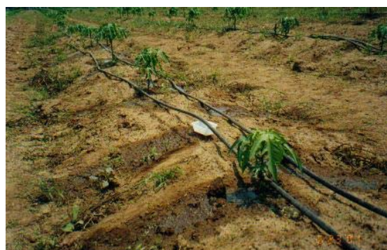
Foto 35. Toma de muestra para determinar Coeficiente de Uniformidad en Sistema de Riego por Goteo. CUCBA
