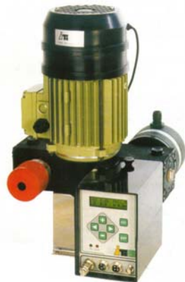
Foto 24. Controlador de ferti-riego. Controller 2000 ITC
