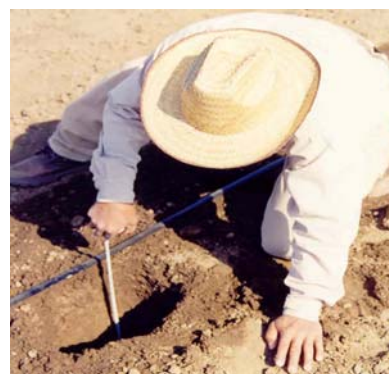
Figura 2. Medición del diámetro y profundidad de mojado de la cinta de riego
