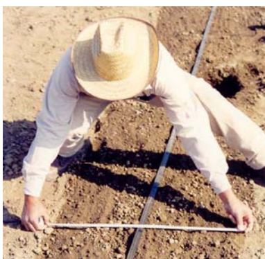
Figura 2. Medición del diámetro y profundidad de mojado de la cinta de riego
