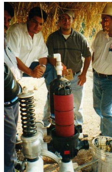
Foto 16. Filtro de anillos instalado. CCAT. La Huerta, Universidad de Guadalajara, México
