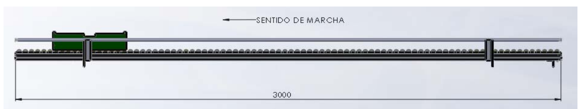
FIGURA 12. Detalle lateral del Tramo Minicarril
