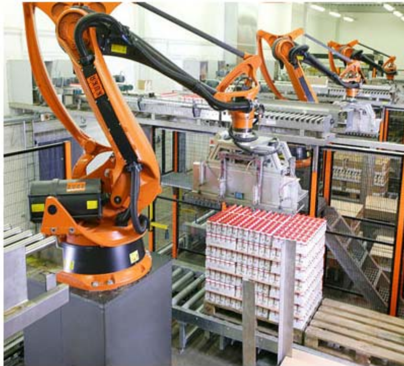
En la actualidad la principal aplicación de la robótica en la industria alimentaria es el transporte y almacenaje de paquetes terminados.
