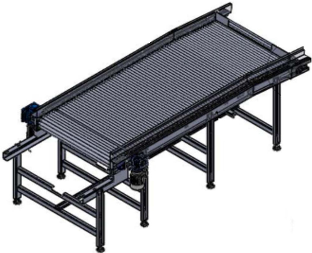
Transportador de rodillos para el tomate posible ubicación de operarios para triaje
