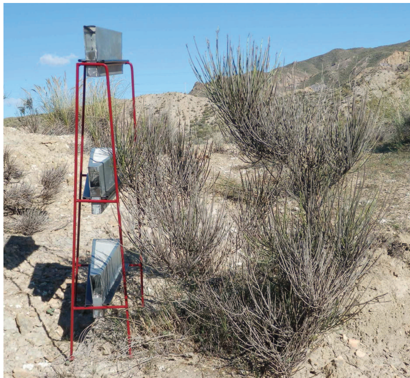
Foto. Nº. 17. Modelo adaptado del colector BSNE de Fryrear. (Asensio et al., 2013)
