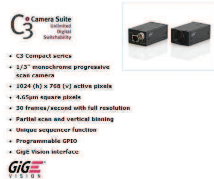
Fig. N° 3. Características técnicas de la cámara JAI-CM080 , ( http://www.jai.com/en/products/cm-080ge , 2013)
