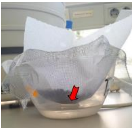
Figura 19.- Método de Whitehead para la extracción de nematodos filiformes y móviles del suelo
