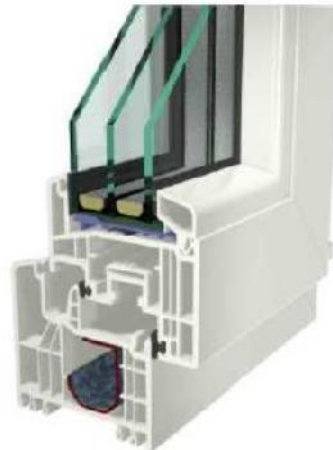
Figura 68. Detalle de ventana pasiva. Fuente: "Passive-On Project", 2005.
