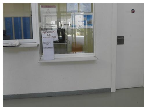
Fotografía 36 y 37: vistas del mostrador, punto de atención accesible, con puerta de acceso de trabajadores son hueco de paso de 0,725 m, inferior a los 0,80 m permitidos.
