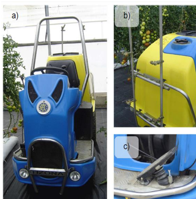
Ilustración 4.- a) Vehículo autopropulsado Tizona®19 equipado con barras verticales de pulverización. b) Detalle de las barras verticales de pulverización en la parte posterior del vehículo. c) Detalle del pedal de aceleración del vehículo. (Castillo, 2012)
