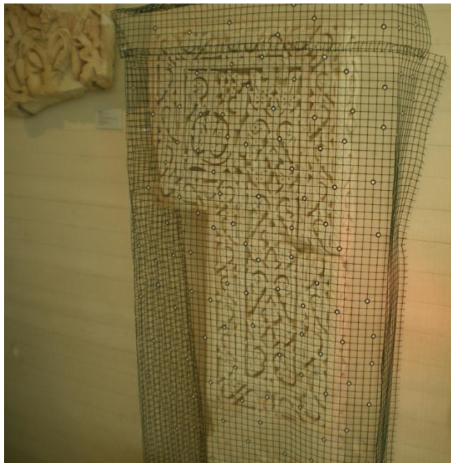
Imagen 26. Primera pieza digitalizada en Madinat al-Zhara, colocación de la malla flexible con las target tipo black contour.
