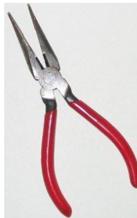
Imagen 11. Alicates de punta larga para la flexión y dobles de la malla.
