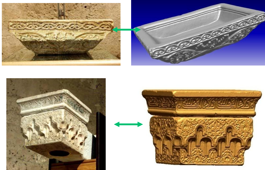
Imagen 37. Resultados obtenidos con el escaneo 3D mediante malla flexible.
