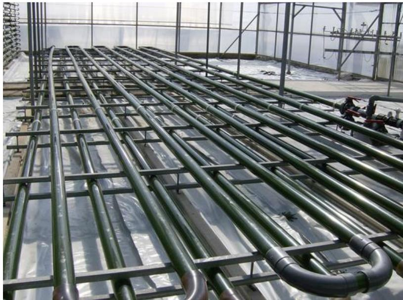
*Figura 3.4. Fotobiorreactor horizontal [11].*
