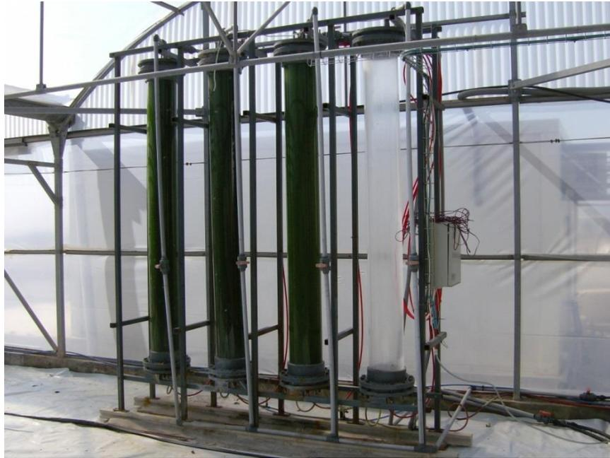
*Figura 3.3. Columnas para la preparación del cultivo [11].*
