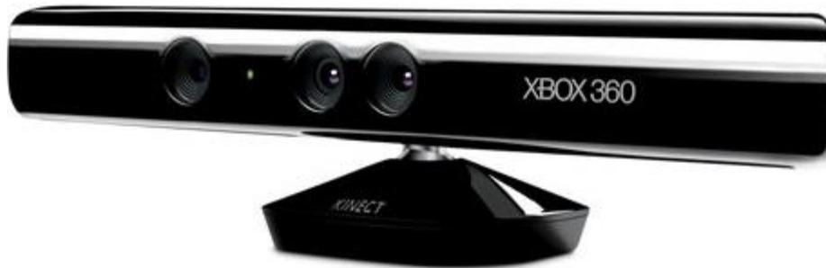
Figura III-6. Sensor Kinect de Microsoft
