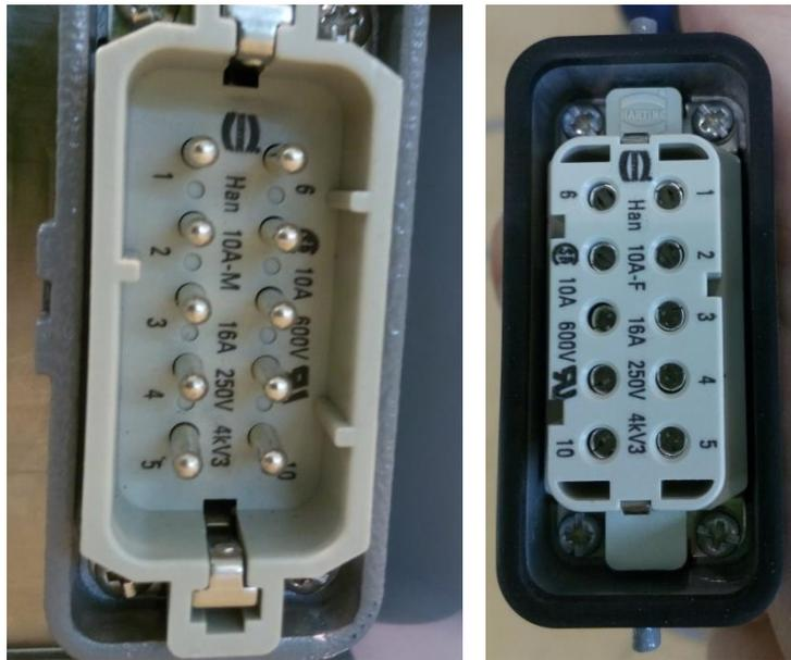
Figura IV-2. Numeración de pines macho y hembra para las conexiones HAN 10A
