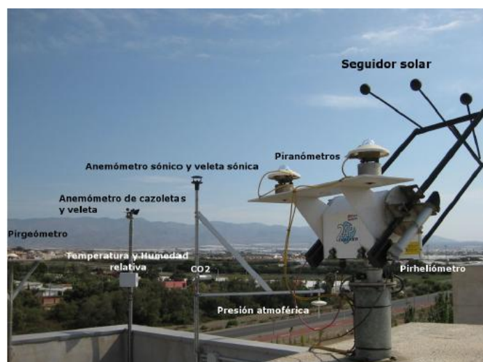
Figura 3.14. Sensores en la estación meteo-radiométrica del CDdi-CIESOL-ARFRISOL.
