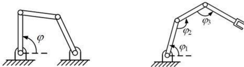
Figura 54. Coordenadas independientes en cadena cerrada (izquierda) y en cadena abierta (derecha).
