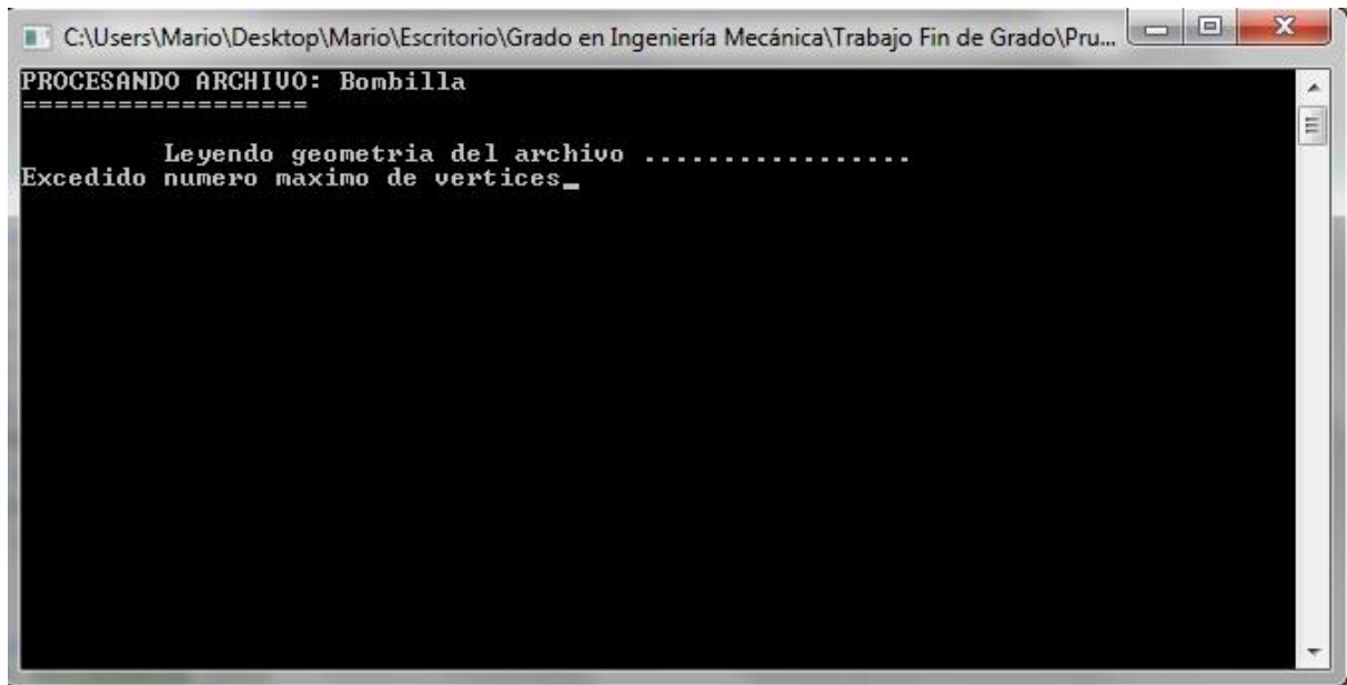
Ilustración 22: Mensaje de error en la lectura de las coordenadas.
