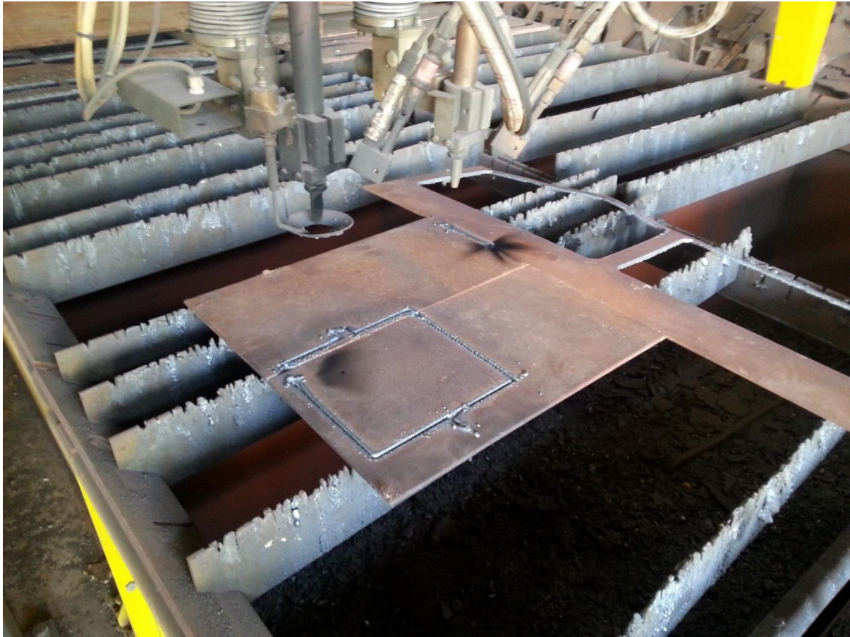
Ilustración 36: Resultado del mecanizado en chapa de hierro de un ejemplo cuyo código numérico ha sido obtenido con el programa CNC Creator.
