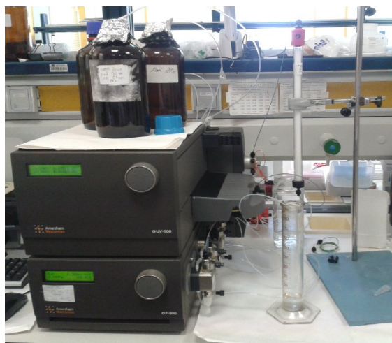
Figura III-9. Equipo cromatográfico de FPLC ÄKTA Basic (GE Healthcare)
