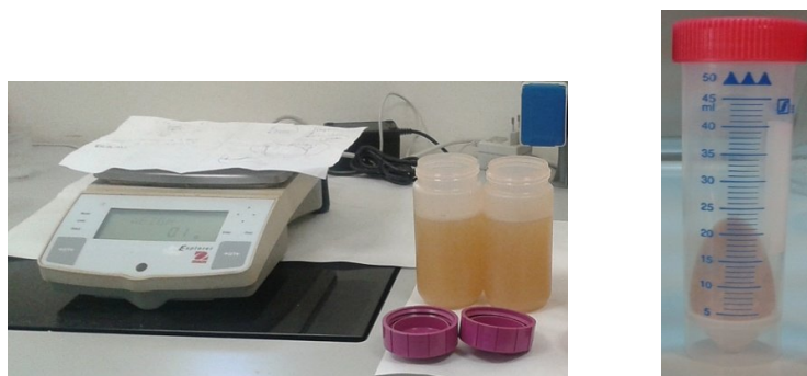
Figura IV-1. Imagen de la balanza con los medios de cultivo para equilibrar (izquierda) y precipitado de células final (derecha)
