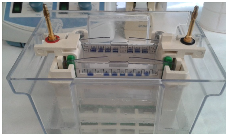
Figura III-7. Esquema (izquierda) e imagen (derecha) del montaje de la cubeta de electroforesis.
