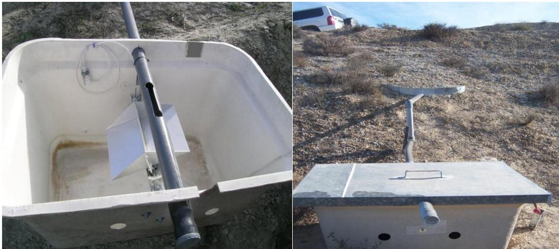
Figura 5. A la izquierda: una ladera cubierta por líquenes junto con el depósito que recoge la escorrentía. A la derecha: foto del depósito donde se observa el balancín con el que registramos la escorrentía.
