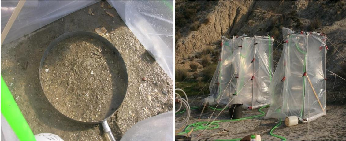
Figura 4. A la izquierda aro delimitando una parcela donde se está llevando a cabo una simulación de lluvia. A la derecha las cabinas donde se realizaron las simulaciones.
