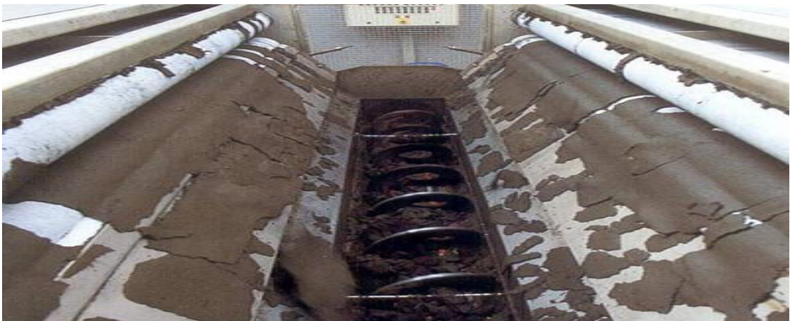
Imagen 13: Ejemplo de un tipo de deshidratador de fangos
