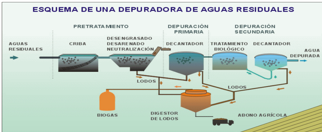
Imagen 2: Esquema de una EDAR
