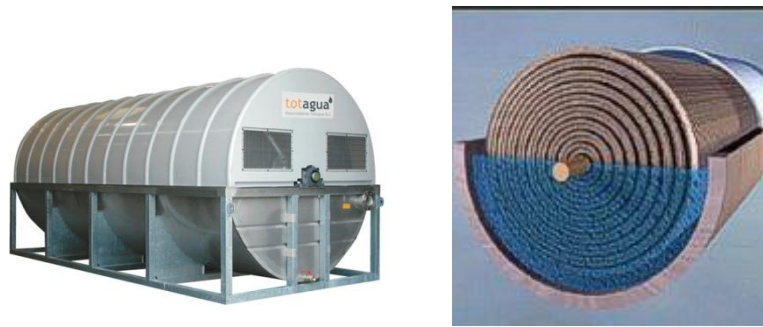
Imagen 5: Ejemplo de cultivo fijo: biodiscos. Vista exterior e interior
