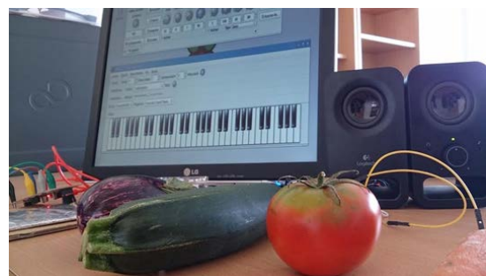
Figura 1: Piano con frutas y hortalizas basado en Raspberry y módulo Makey-Makey.
