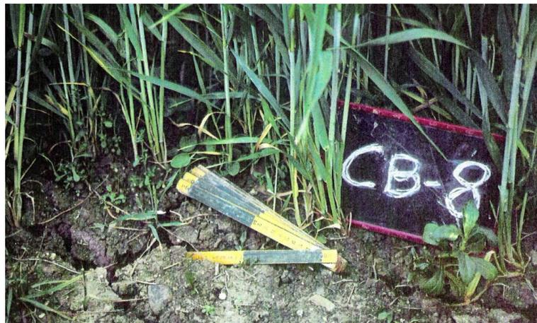
**Foto 3 .-** Detalle del agrietado del *Vertisol eútrico* (FAO, 1990) o Haploxerert típico (USDA, 1997).
