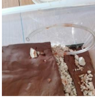
Ilustración 13 Capa de arcilla superior Fuente: Elaboración propia
