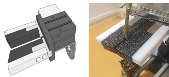
Figura 40. Sistema flexible para cogida de plántula.
