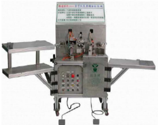
Figura 11. Máquina de injerto para solanáceas de TDARES.
