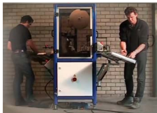
Figura 15. Modelo ISOgraft 1100 de ISO Group para injerto de solanáceas.
