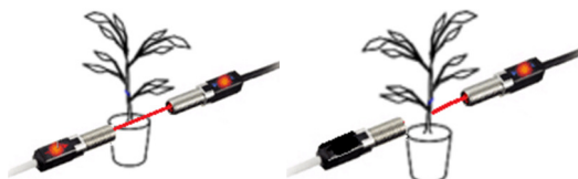
Figura 41. Funcionamiento básico del sensor fotoeléctrico de barrera
