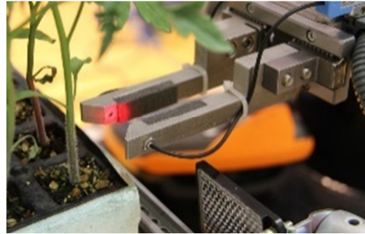
Figura 43. Pruebas del gripper con detección de plántula
