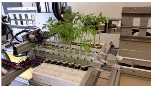
Figura 22. Equipo robótico para injertos Robotgraft de Virentes.
