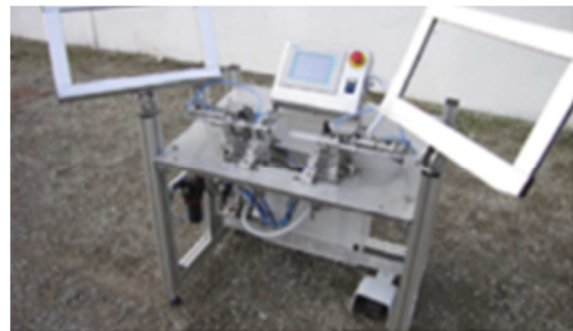
Figura 17. Equipo para injerto de cucurbitáceas GR300/3 de Atlantic Man.
