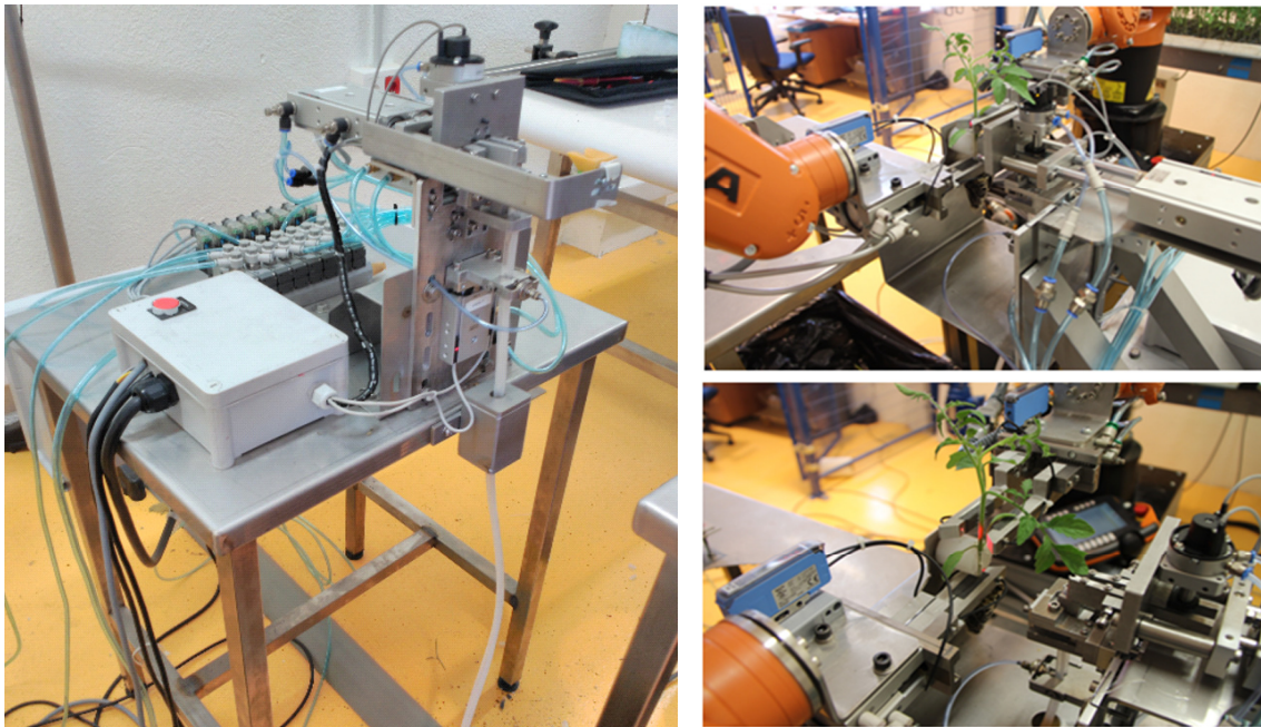
Figura 51. Sistema de dispensación de clip de injerto
