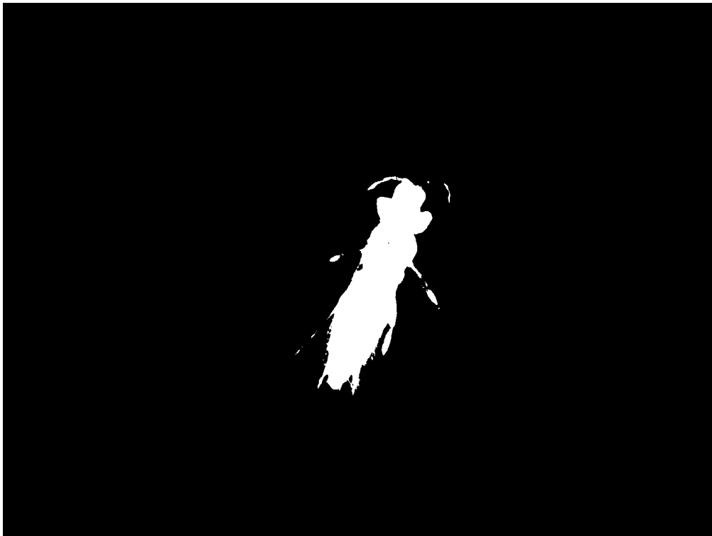
Figura 4.3: Segmentación de la banda azul de la imagen por el Método de Otsu .
