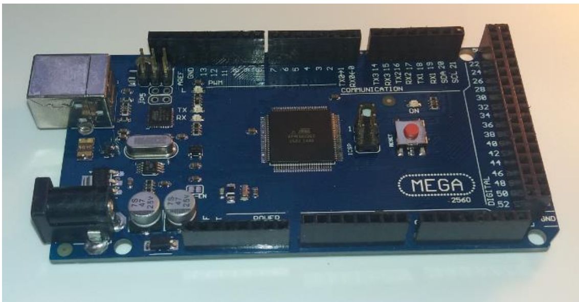
Figura 16. Placa Arduino MEGA 2650.
