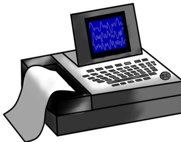
Figura 6. Electrocardiógrafo basado en amplificación electrónica con registro escrito.
