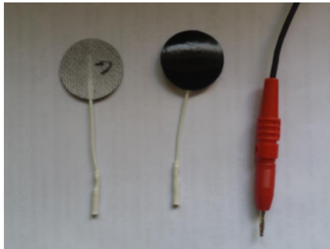
Figura 13. Electrodo superficial con conector de banana (extremo derecha).
