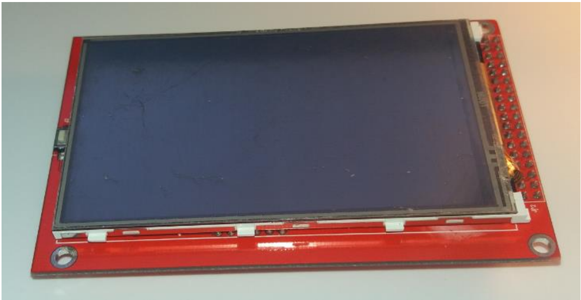
Figura 19. Periférico TFTLCD para Arduino (Arduino, 2005).
