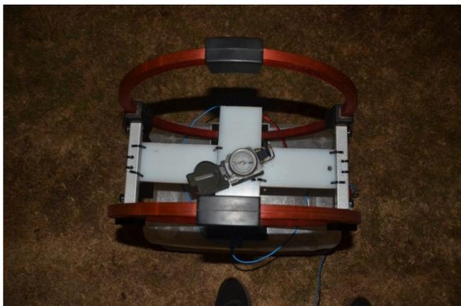
Figura 5-6: Brújula apuntando al este en el interior de la bobina de Helmholtz.
