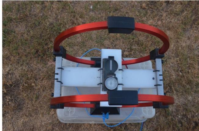
**Figura 5-5: Disposición inicial de la bobina de Helmholtz.**
