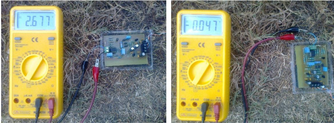
Figura 5-8: Lecturas del magnetómetro en orientación norte y este.
