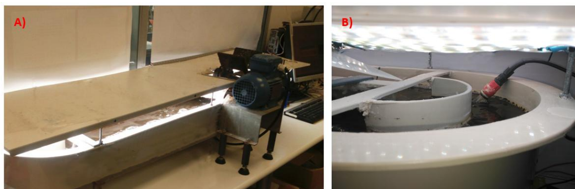
Figura 5. a) Vista general del FBR b) Vista detallada del panel LED
