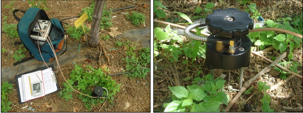
Figura 14. Detalle de unas varillas junto a una parra. Registro del contenido de agua en el suelo en la parcela de ensayo con el equipo TDR.
