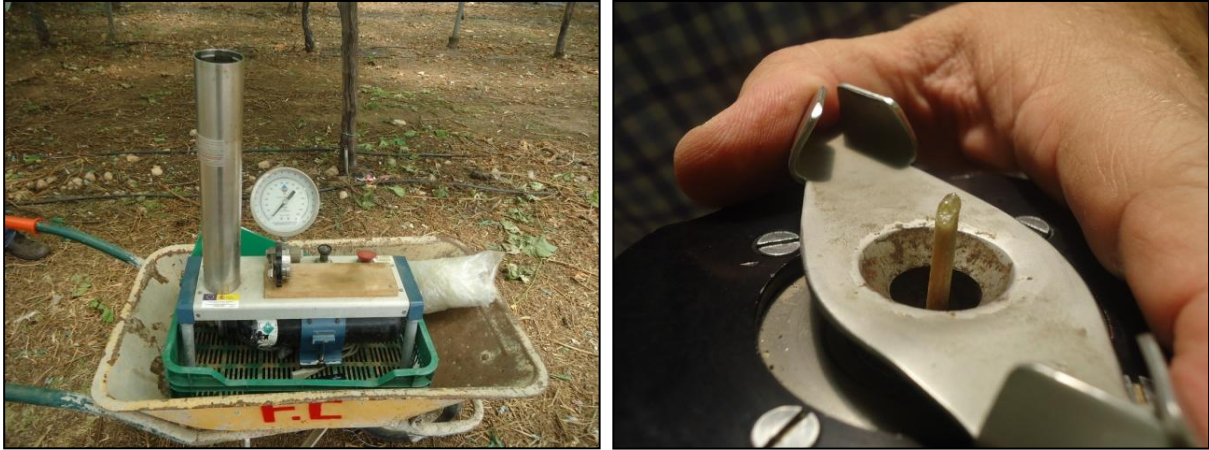
Figura 15. A la izquierda, cámara de presión tipo Scholander, modelo 3000 de Soil Moisture Equipment Corporation. A la derecha detalle de la savia sobre el corte del peciolo.
