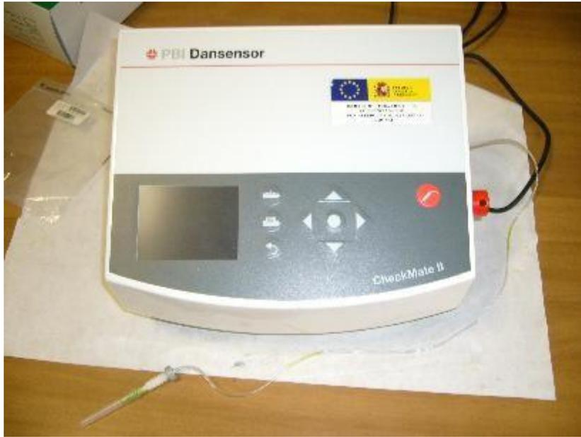
**Figura 24.** Analizador fijo de O<sub>2</sub>/ CO<sub>2</sub> “CheckMate II”
