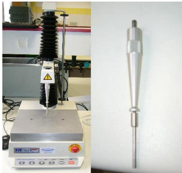
**Figura 19.** Texturómetro del laboratorio 222 de la Escuela Superior de Ingeniería de la Universidad de Almería y detalle de la sonda del texturómetro.
