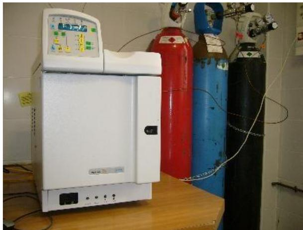
Figura 23. Cromatógrafo de gases utilizado para medir etileno.
