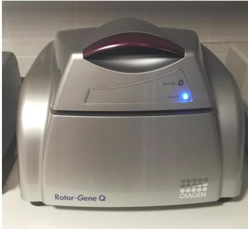
**Figura 20.** Termociclador (Rotor-Gene Q) utilizado para analizar la acumulación del virus en cada muestra de hoja.
