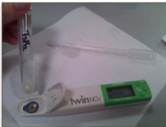
Figura.11: Medidor de nitratos cardímetro Cardy Twin Nitrate Meter B-343 (Horiba, Kyoto, Japón).
