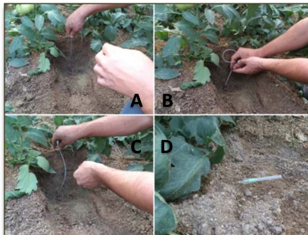
Figura.9: Instalación de sondas: Perforación con alambre con \emptyset de sonda (A), inserción de la sonda (B), nivelado de capa de arena (C) y Resultado final (D).
