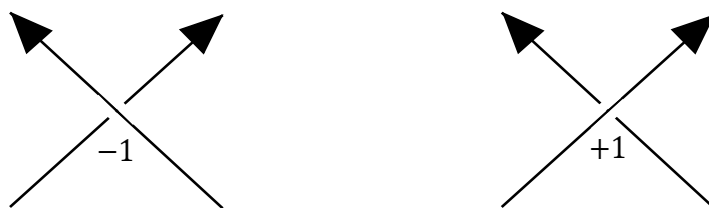
Figura 4.3: Izquierda: un cruce con la fecha que cruza por encima hacia la izquierda contribuye -1 a la suma utilizada para calcular los números de enlace. Derecha: un cruce con la flecha que cruza por encima hacia la derecha contribuye +1 a la suma utilizada para calcular los números de enlace
