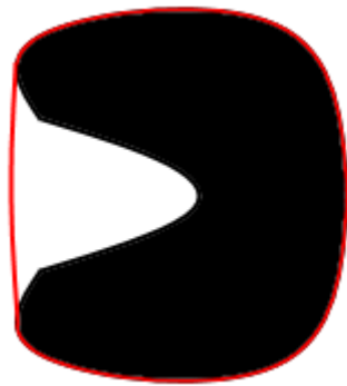
Figura 3.9: Illustrazione della Convex Hull Area. In nero è rappresentato l'oggetto, mentre la linea rossa indica il più piccolo poligono convesso che contiene tutti i punti dell'oggetto.
