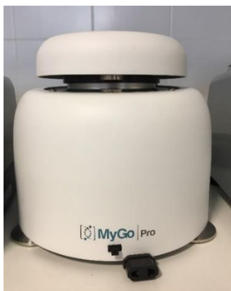
Figura 21. Termociclador MyGo Pro utilizado para analizar la acumulación relativa de virus en las muestras vegetales.
