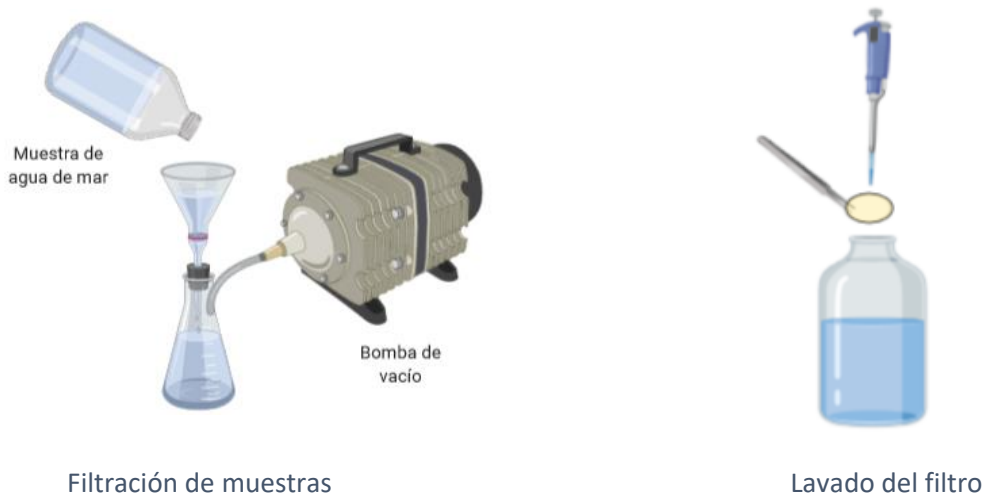
Figura 4. Concentración de la biomasa microbiana procedente de 1L de muestra de agua de mar en 100 mL de agua estéril.
