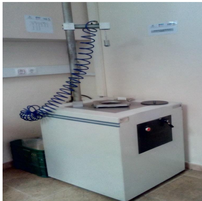
Imagen 22. Impactómetro CEAST L-5.
