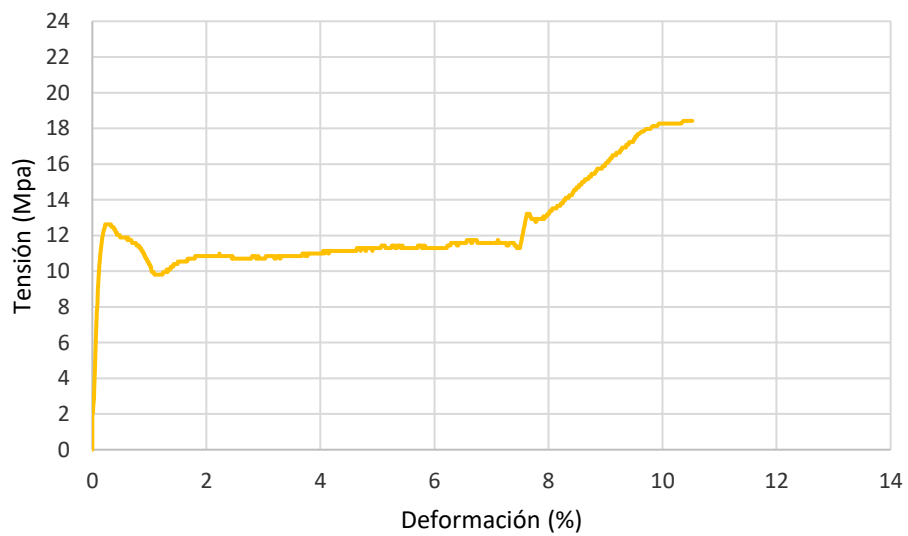
Gráfica 65. Curva tensión-deformación de la probeta nº2 CPE 3 (D.T).
