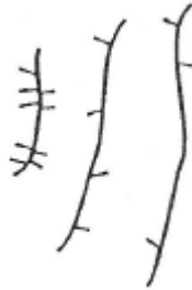
Imagen 3. Estructura esquemática del LLDPE (Muñoz, 1999).
