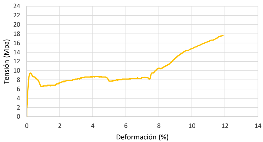
Gráfica 67. Curva tensión-deformación de la probeta nº4 CPE 3 (D.T).
