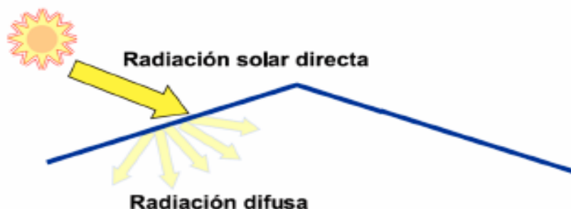
Imagen 10. Difusión de la luz solar al atravesar una cubierta plástica (Hernández et al. , 2001).
