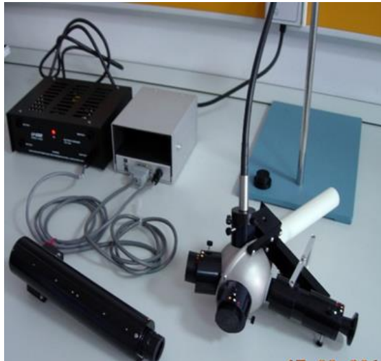
Imagen 17. Partes del espectroradiómetro.
