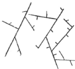
Imagen 2. Estructura esquemática del LDPE (Muñoz, 1999).
