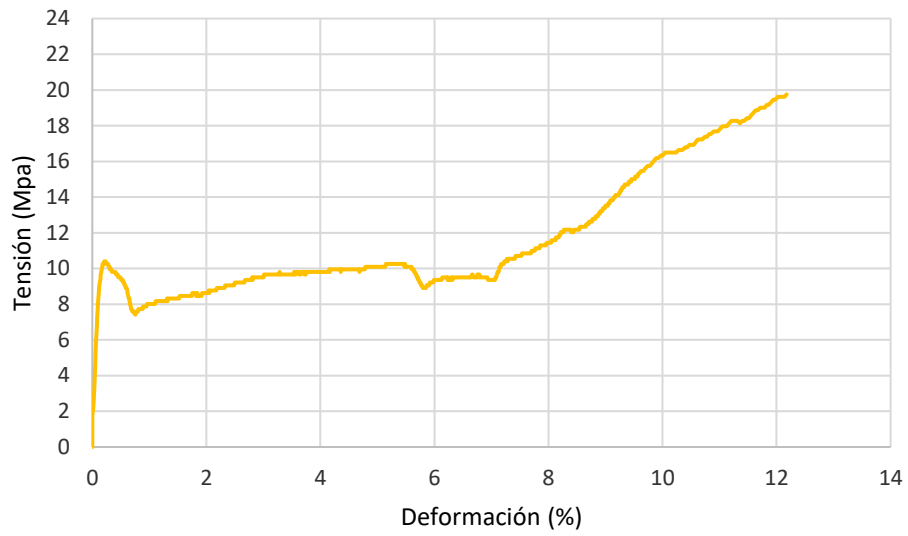
Gráfica 64. Curva tensión-deformación de la probeta nº1 CPE 3 (D.T).
