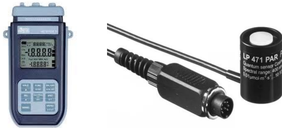
Imagen 25. Sensor DELTA OHM para la medida de radiación PAR.
