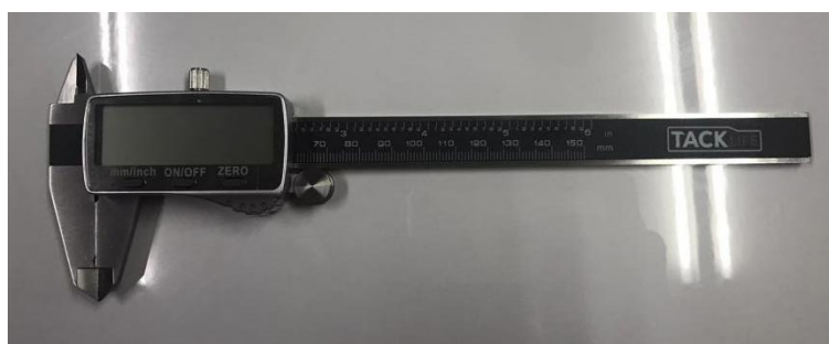
Figura 18. Calibre Tack life™ con una sensibilidad de 0,03 mm. Fuente: elaboración propia
