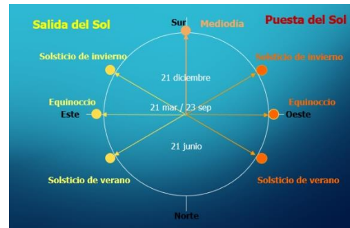
Figura 2. Valores del azimut del orto y el azimut del ocaso en Almería los días singulares del año
