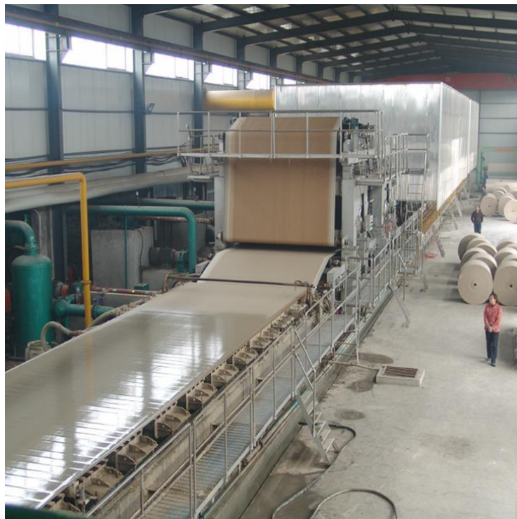
Figura 3.13. Tamiz de alambre con la pulpa con mucha humedad al principio del recorrido y menos humedad al final.
