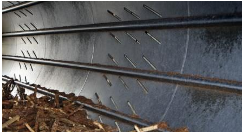
Figura 3.12. Descortezadora de tambor usada en la fabricación de papel.
