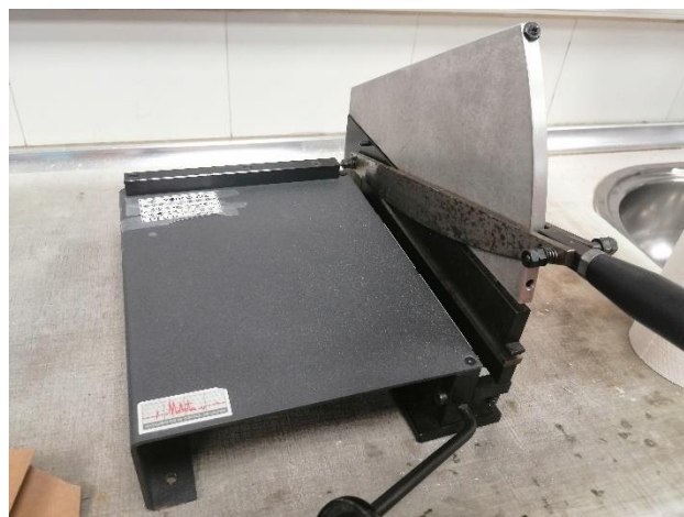
Figura 4.40. Cuchilla doble. La parte superior es el apoyo para poder cortar las muestras.
