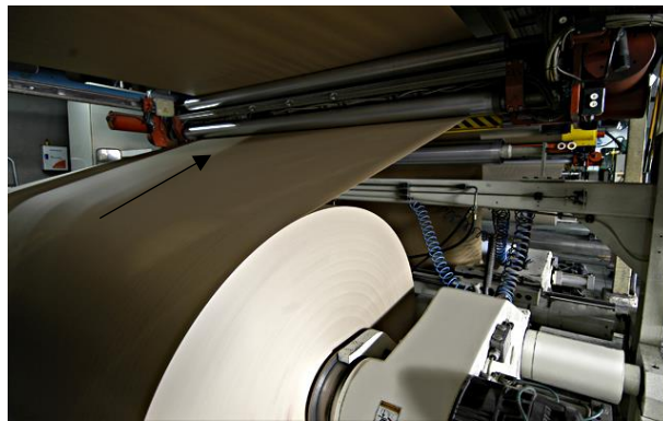
Figura 4.33. Bobina en la onduladora. La flecha sobre la bobina marca la dirección de máquina.
