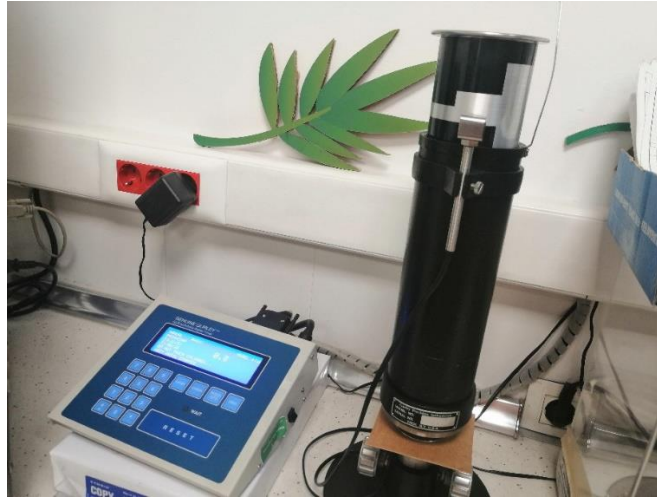
Figura 4.44. Permeabilímetro Gurley usado. Se puede ver el sensor con las marcas para iniciar y parar el cronómetro.
