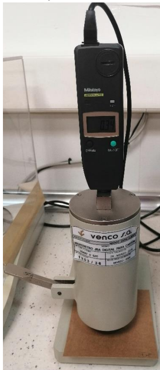
Figura 4.45. Micrómetro para cartón JBA. La palanca de la izquierda sirve para levantar el peso muerto.
