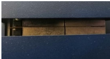
Figura 4.42a. Mordazas sujetando y ensayando una muestra.
