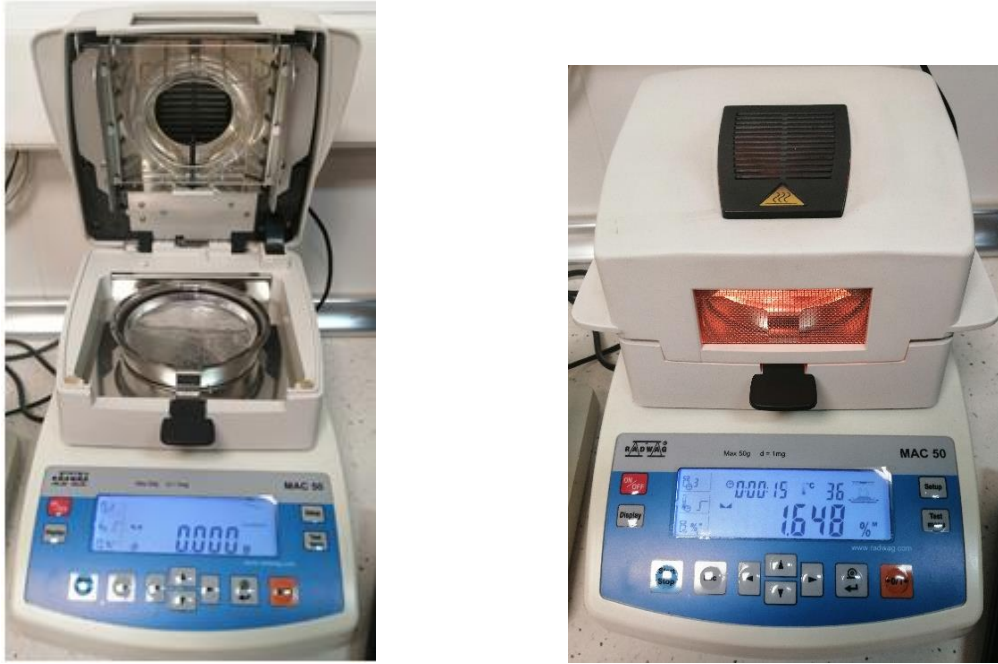
Figura 4.36. Balanza Radwag abierta preparada para colocar la muestra (izquierda) y funcionando (derecha).
