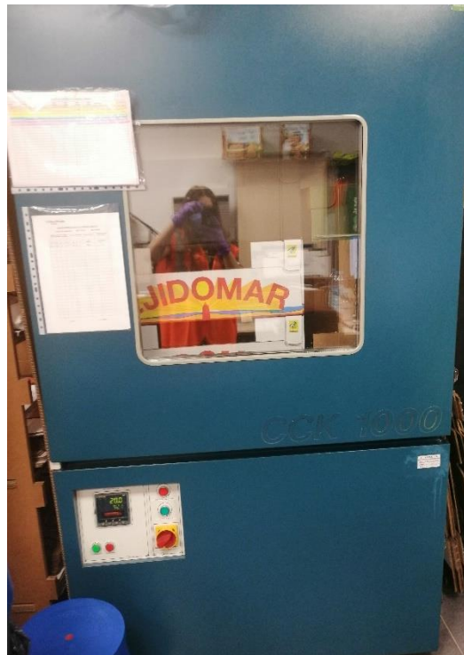
Figura 4.37. Cámara climática Dycometal con cajas para ensayar en su interior.
