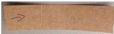
Figura 4.42b. Muestra de papel ensayada donde se nota la zona de ensayo por el abultamiento debido a la deformación
