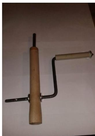
*Figura 15. Accesorio con agujeros pasantes y manivela para el montaje de la vela*
