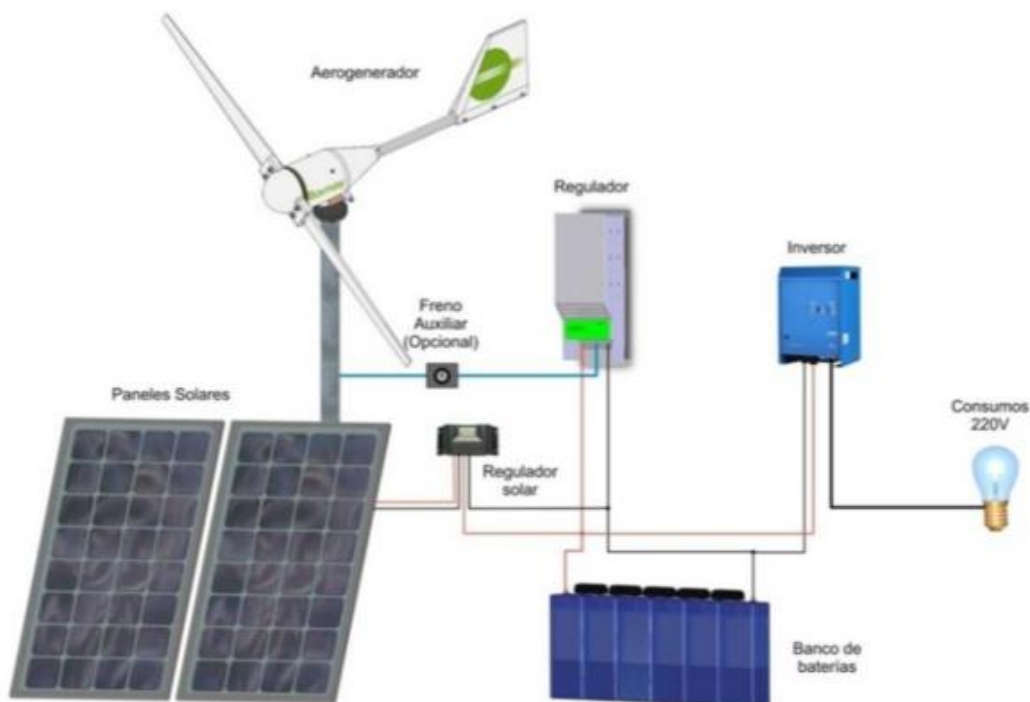
Figura 22. Configuración de instalación mixta
