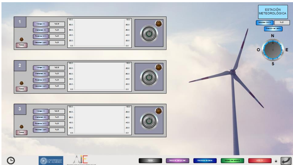
Figura 42. Ventana de Producción Eólica SCADA
