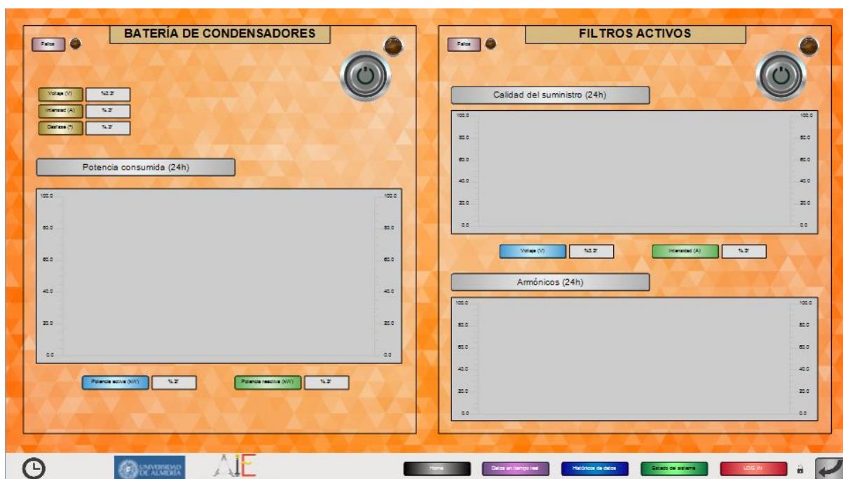
Figura 40. Ventana Calidad de Suministro SCADA
