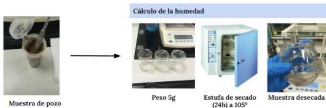
**Figura 7.** Método de análisis de humedad en muestras de suelo.
