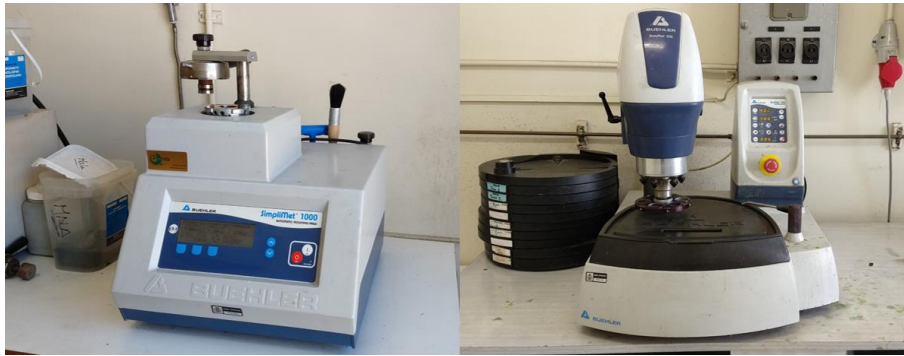
Figura 8.8: Embutidora (izq.) y pulidora (dch.) para preparación metalográfica (CIEMAT).
