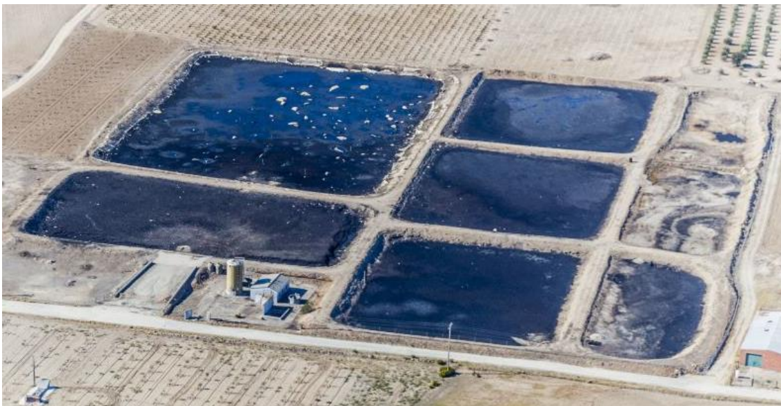
Figura 4. Balsas de evaporación de alpechín ubicadas en el municipio de Mora (Toledo).
