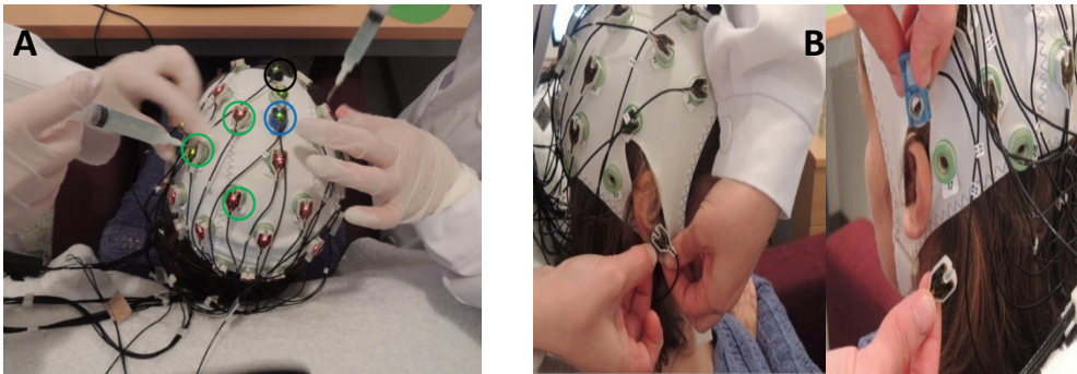
Figura 10. (A) Diferencia de potencial (derivación) entre electrodo activo (en verde) y de referencia, FCz, en azul. (B) Re-Referenciado ( A_1 , A_2 ).
