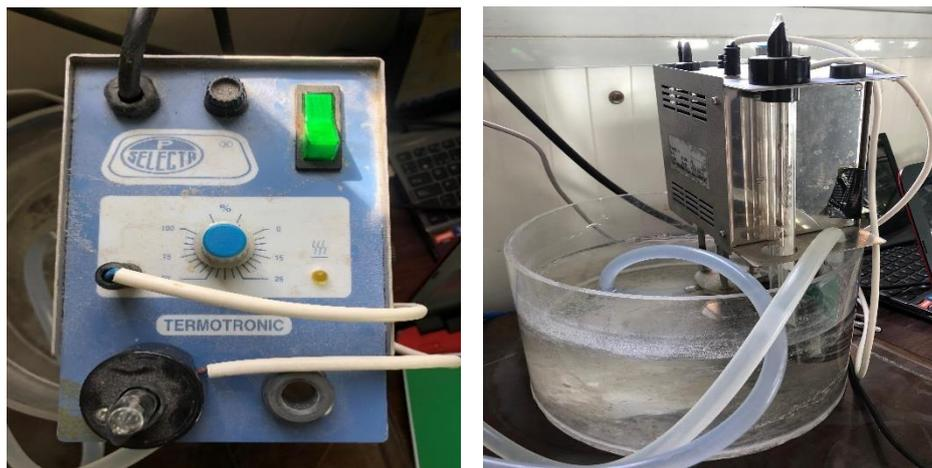
Figura 10. Intercambiador frío/calor utilizado en los ensayos
