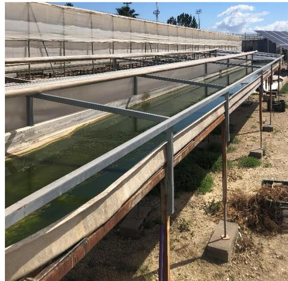
*Figura 1. Fotobiorreactor externo tipo Raceway (izquierda) y tipo Thin Layer (derecha)*
