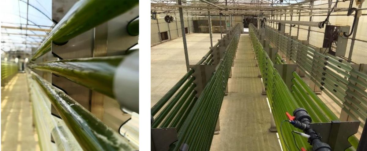
*Figura 2. Fotobiorreactor tipo tubular*
