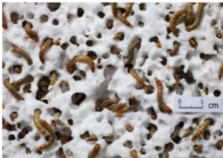
Figura 10. Larvas de Tenebrio molitor degradando un sustrato de PS (Imagen tomada de Yang, 2015b)
