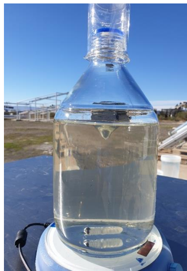
Figura 3.22 - Reactor solar de 2 L expuesto a la luz solar natural.
