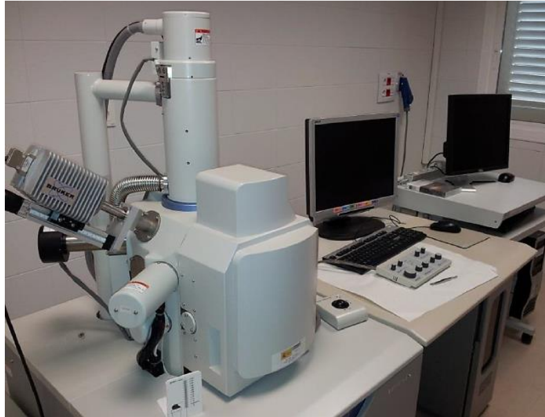
Figura 3.18 - Microscopio Electrónico de Barrido (Hitachi S-3400N) disponible en el Laboratorio de Tratamientos Solares de Agua de las instalaciones de la PSA.
