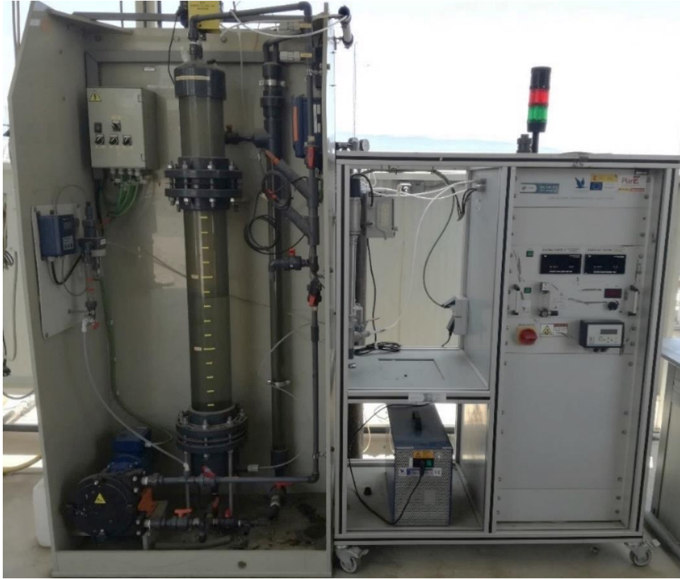
Figura 3.26 - Planta piloto de ozonización ubicada en las instalaciones del Laboratorio de Tratamientos Solares de Agua de la PSA.
