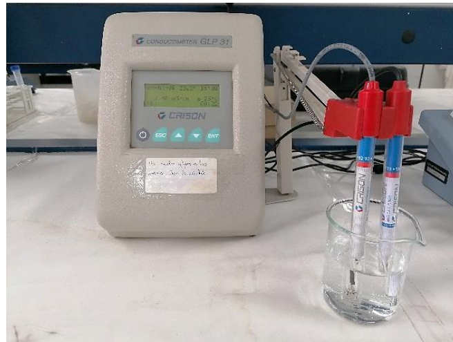
Figura 3.5 - Medidor de conductividad disponible en el Laboratorio de Tratamientos Solares del Agua en la PSA.
