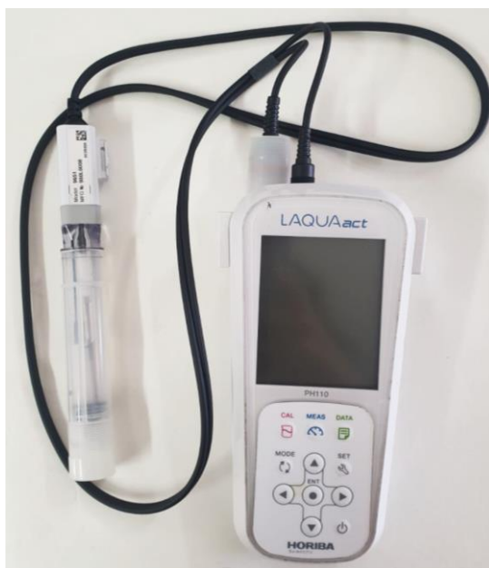
Figura 3.4 - pH-metro portátil LAQUAact PH110 utilizado para determinar el pH.
