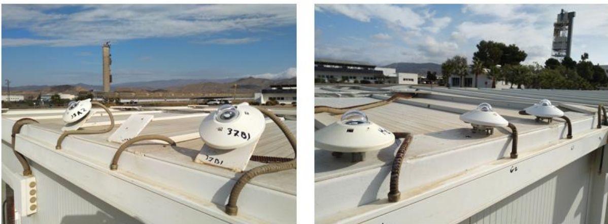
Figura 3.19 - Radiómetros de la estación de radiación solar del Laboratorio de Tratamientos Solares de Agua de la PSA
