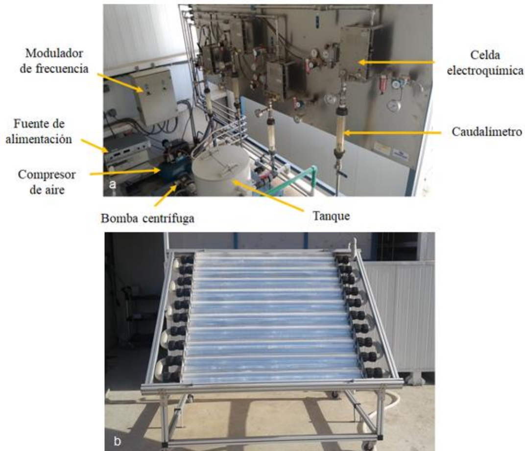
Figura 3.29 - Imágenes de los principales componentes de la planta piloto electroquímica: a) Electro MP-Cells, b) Fotorreactor solar CPC.
