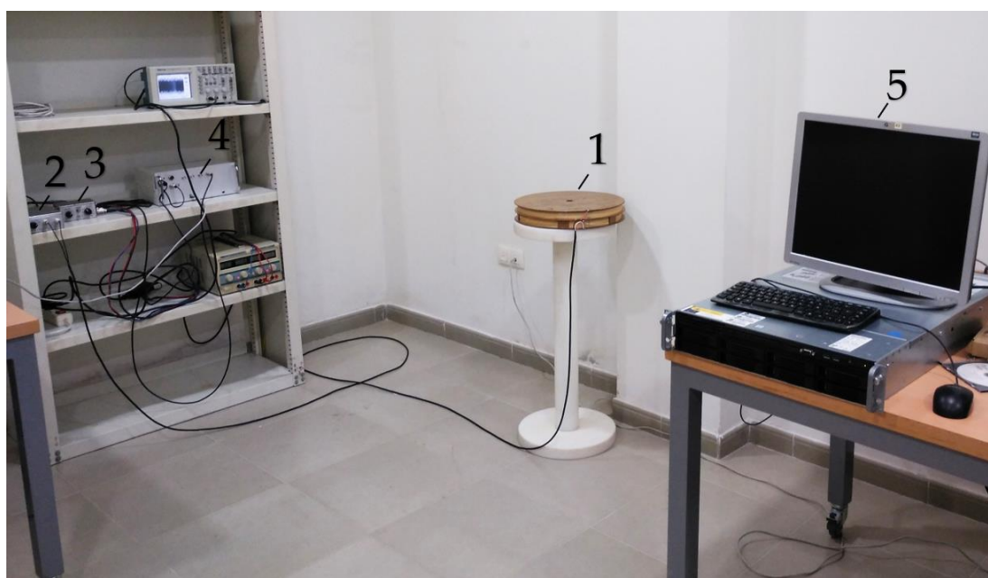
Fig. 36. Sistema instalado en el laboratorio: 1. Magnetómetro ELF; 2. Amplificador de instrumentación; 3. Amplificador final; 4. ADC+DSP; 5. Servidor de cálculo.
