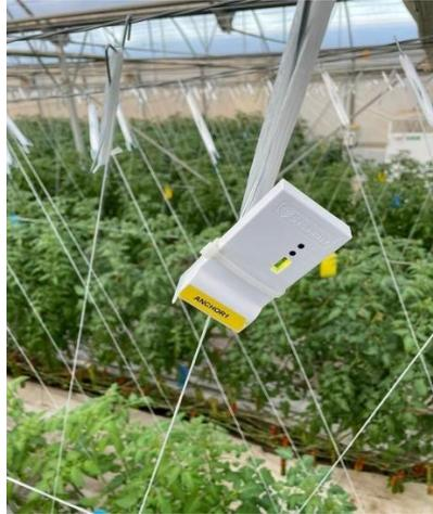
Figura 49: Sujeción de las balizas
