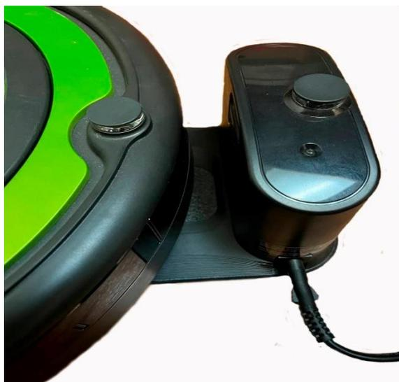
Figura 13: Sensor infrarrojo de comunicación
