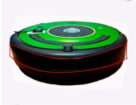
Figura 9: Sensores infrarrojos horizontales
