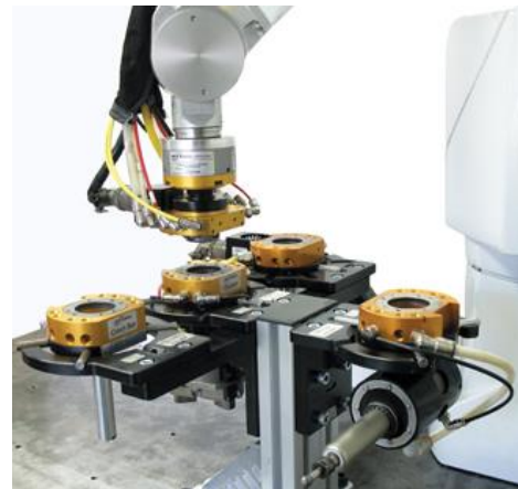
Figura 4. Imagen de un robot industrial con cambiador de elemnto terminal automatico.
