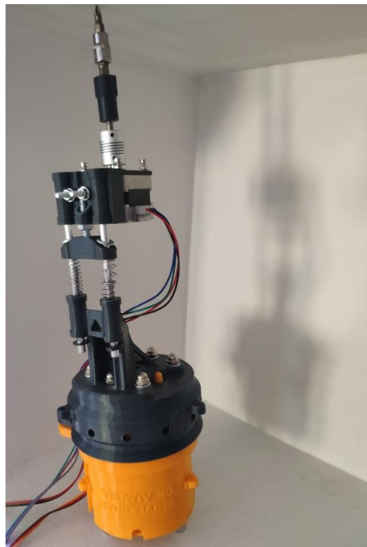
Figura 60. Imagen del acople universal conectado al taladro
