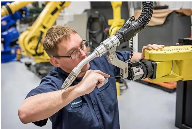
Figura 3. Imagen de operario realizando tarea de cambio de cambio de un elemento terminal de soldadura de un robot industrial.
