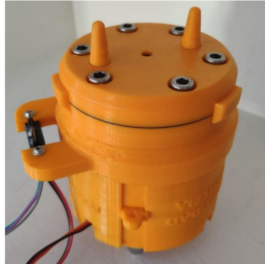
Figura 61. Imagen del prototipo del mecanismo de leva en posición de bloqueo (elemento terminal acoplado)
