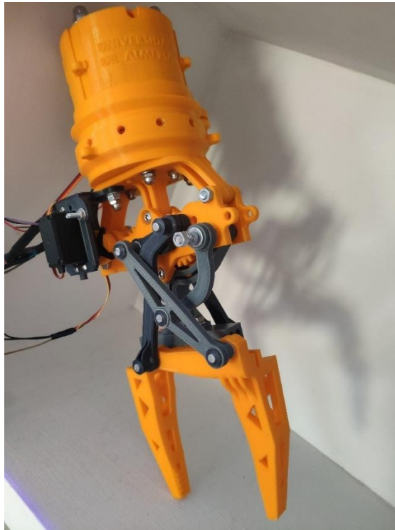
Figura 59. Imagen del acople universal acoplado a la pinza de seis barras
