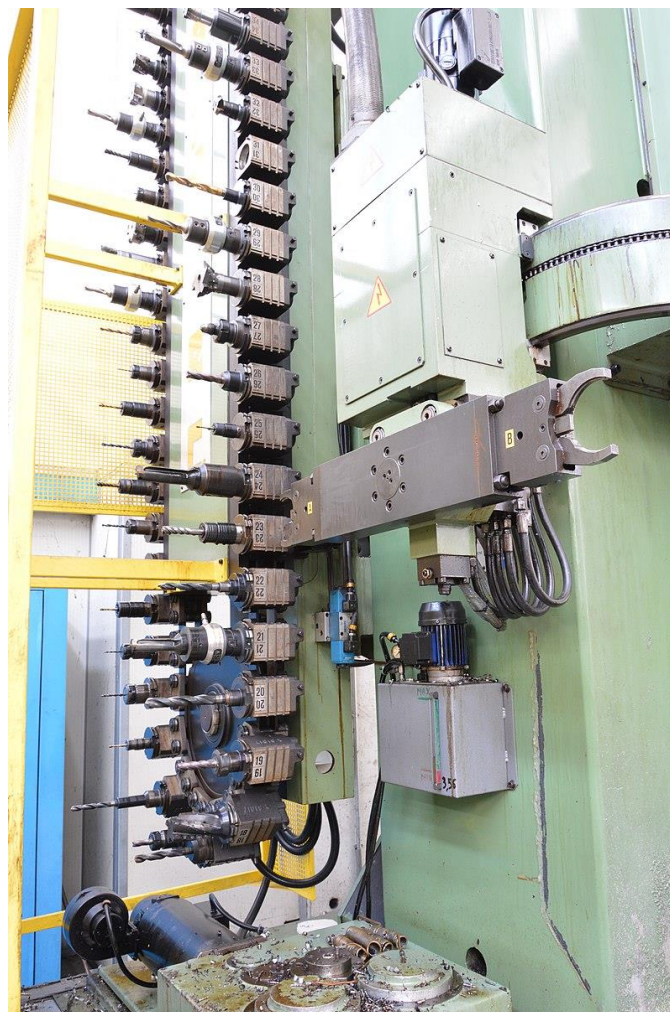
Figura 5. Un cambiador de herramientas automático de tipo cadena con brazo giratorio y dos pinzas
