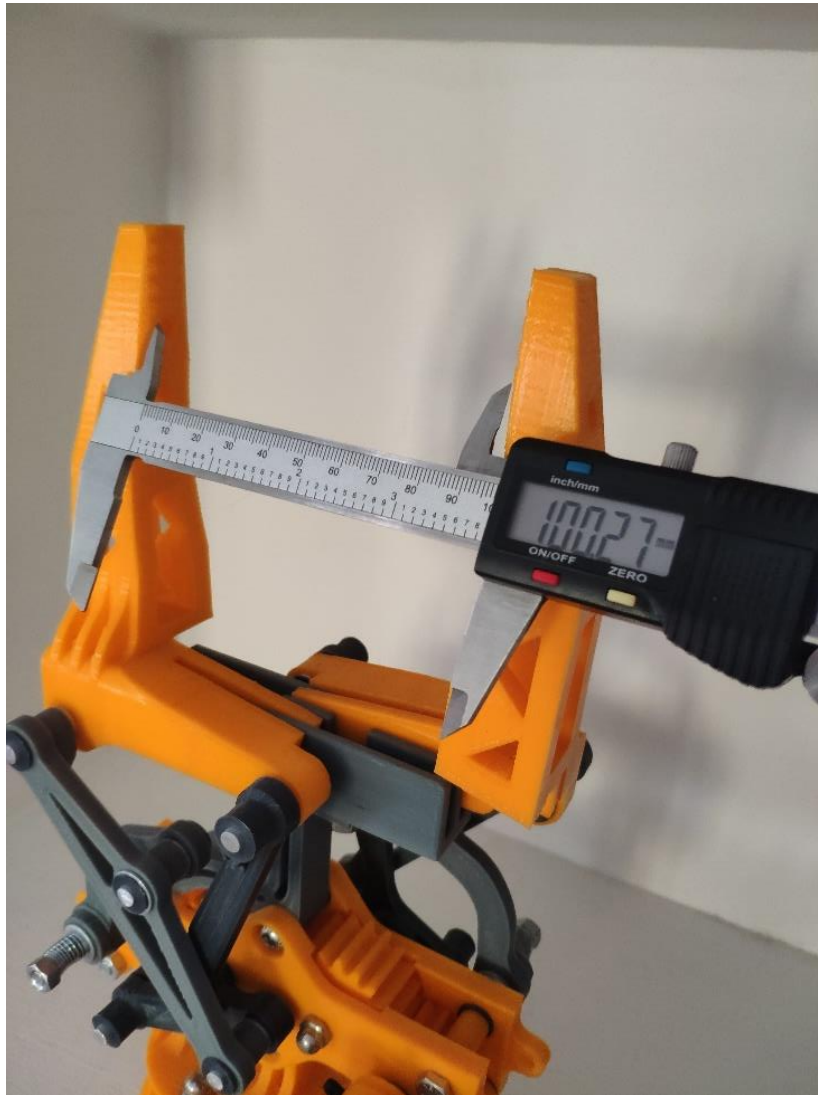
Figura 65. Imagen de comprobación de los resultados de diseño de apertura máxima de la pinza de seis barras
