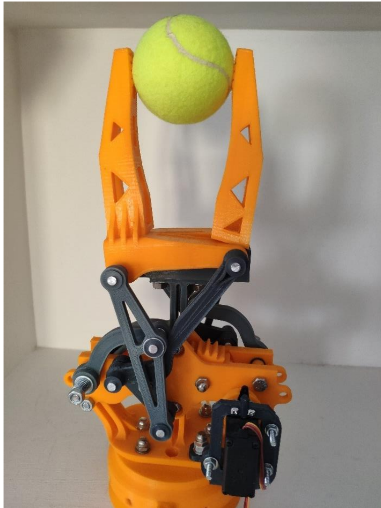
Figura 66. Imagen de la pinza de seis barras y la característica de agarre adaptativo
